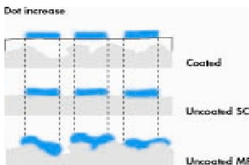
کیفیت کاغذ در مراحل بیش از چاپ باید مد نظر قرار گرفته و کیفیت تراهم قابل دستیابی با نوع کاغذ مورد استفاده باید مد نظر قرار گیرد . بزرگ شدن تراهم ها بدلیل افزایش پوشش مركب باعث تغییر تون رنگی می گردد در این مورد باید اندازه تراهم ها کاهش یابد . اندازه تراهم براساس نوع کاغذ مورد استفاده برای چاپ باید اصلاح شود .
